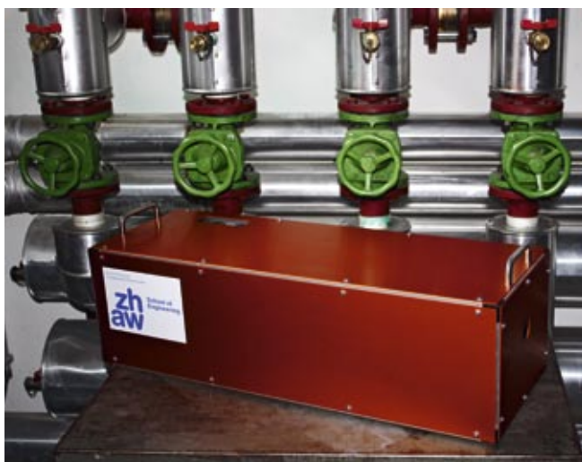
Bild 5 Messsystem im Einsatz bei der Prüfung von Korrosionsschutz-Beschichtungen.
